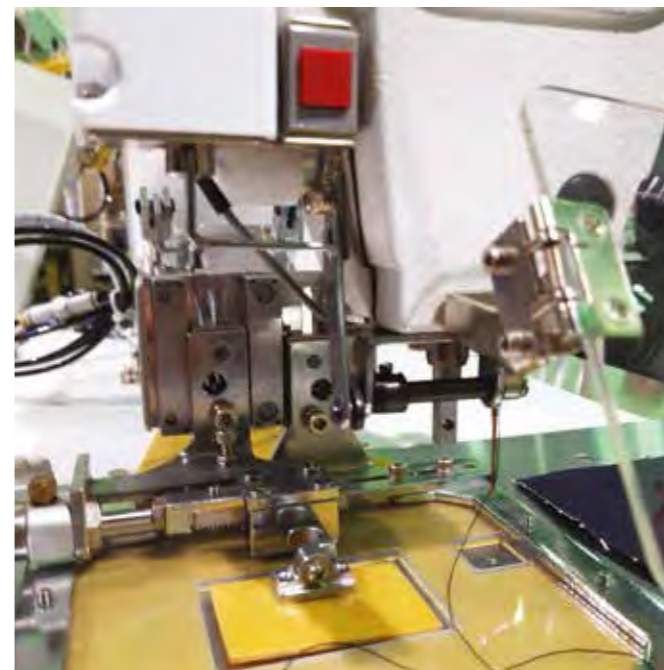
Рис. 3. Полуавтомат для притачивания эмблем по замкнутому контуру BRC-T 2210-F1-D
