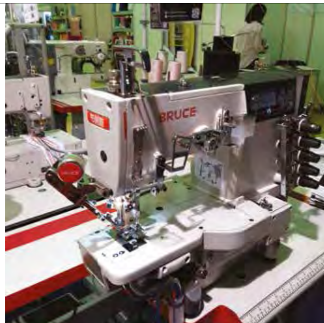
Рис. 2. Машина плоского цепного стежка с левосторонней обрезкой края материала VS-UT-35 ACx356
