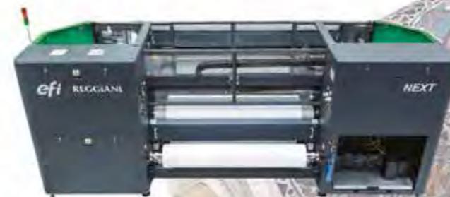
Промышленная цифровая печатная машина EFI Reggiani NEXT. Ширина 1850 - 3400 мм
