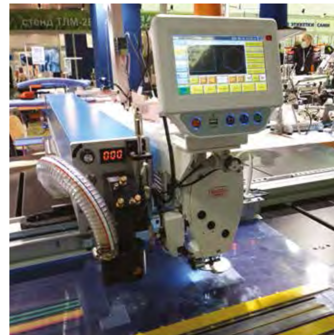
Рис. 4. Шаблонный полуавтомат BRC-T 14090 A-81 STYX/F11 с лазерной установкой
