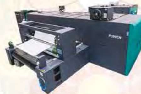
Промышленные цифровые печатные машины EFI Reggiani ReNoir, ширина 180-240-340 см
