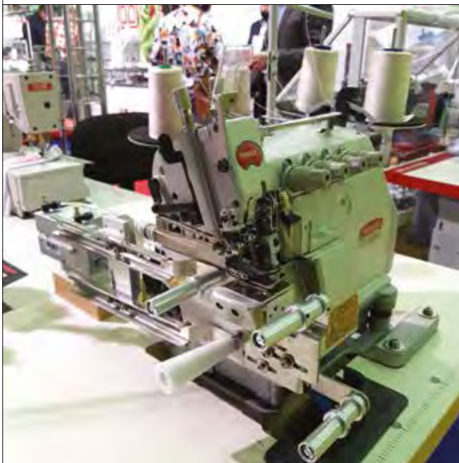
Рис. 1. АРМ для втачивания воротников и поясов, соединенных в кольцо BRC-5114TD-MO3/333/KS/FR06
