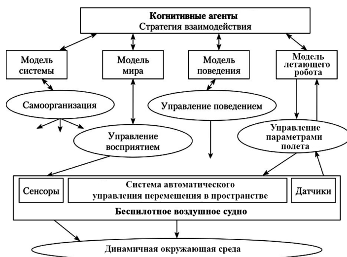
Рис. 2. Когнитивная система беспилотного воздушного судна с ИИ. Составлено автором на основе: [Станкевич, 2023]
