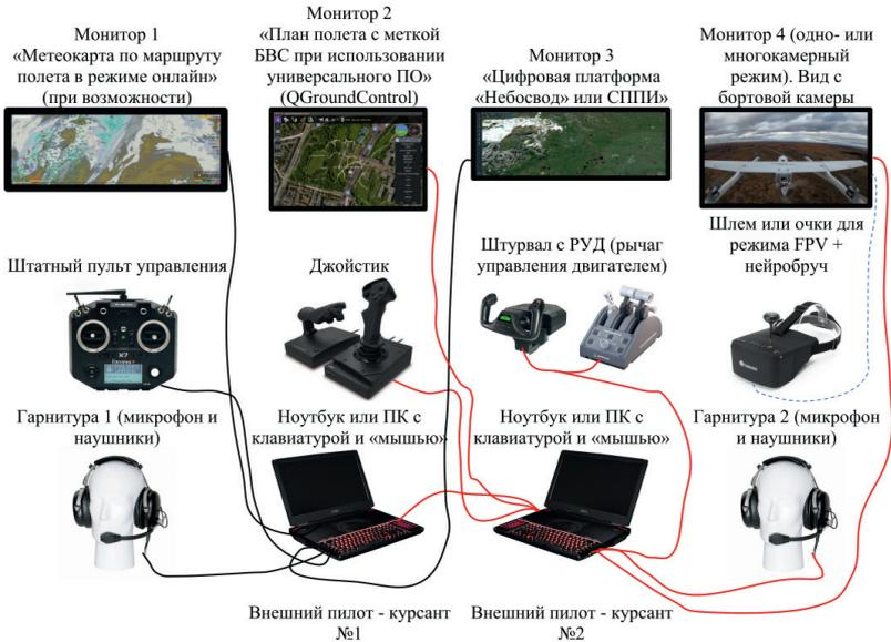
Рис. 13. Примерная схема модулей цифровой подготовки внешних пилотов.
